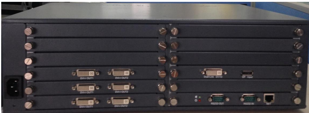
图 5.2: 融合机插卡结构
